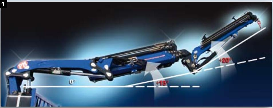
**1** Braccio secondario con extra corsa negativa di 15° e Antenne con angolo negativo di 20°, che minimizzano le flessioni degli sfili idraulici, garantendo un perfetto controllo del carico, in ogni posizione di lavoro.
