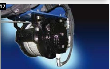
**17** Verricello a gestione elettronica con capacità di carico da 1200 a 2500 Kg, anche con ricarico su antenna.
